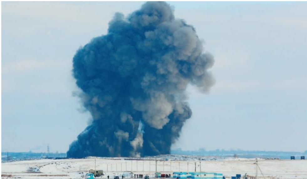
Рис. 2.2. Разрушающий контроль: испытание газопровода под давлением 305 атмосфер.
